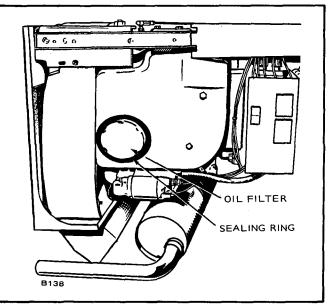
FIGURE 18. OIL FILTER LOCATION (RIGHT SIDE)
