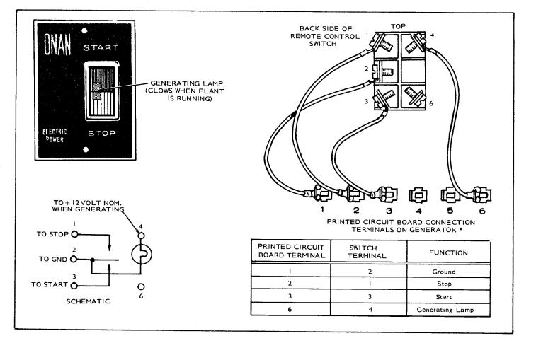
FIGURE 6. REMOTE CONTROL SWITCH (300-0985)
