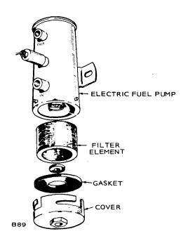
FIGURE 19. FUEL PUMP FILTER ELEMENT
